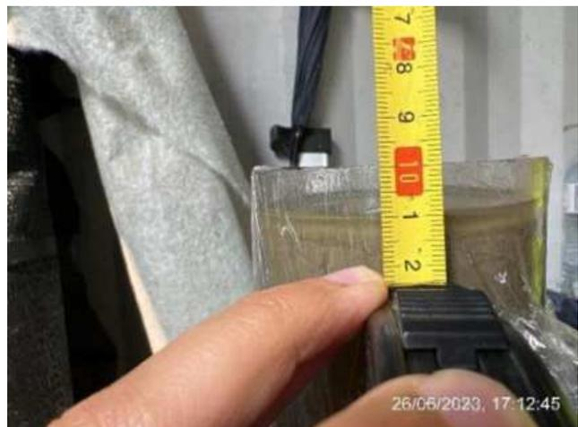
Ensaio de Exsudação após 1,5 horas - Amassadura #2 de 26/06/2023;
