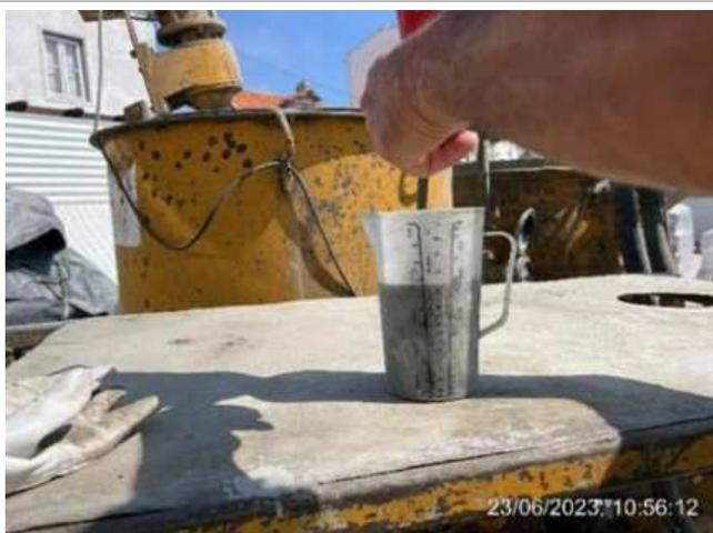
Ensaio de fluidez por "Cone de Marsh" - Amassadura #6 de 23/06/2023, t=8,76s;
