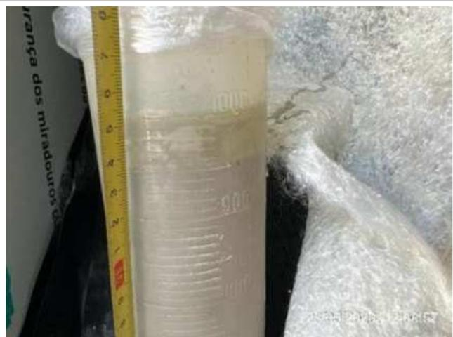
Ensaio de Exsudação após 2 horas - Amassadura #3 de 23/06/2023;
