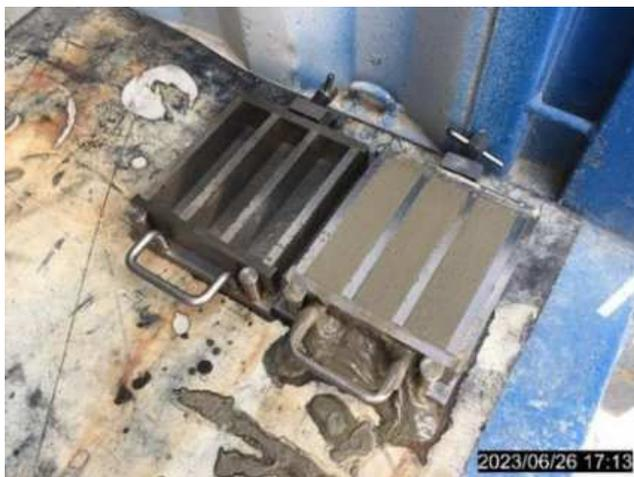
Recolha de provetes de calda de cimento para ensaio à compressão: 3 provetes prismáticos - Amostras recolhidas na amassadura #2 de 26/06/2023;
