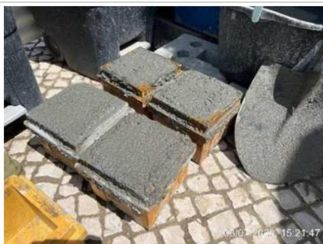
Provetes para ensaio à Compressão, 4 provetes - GR P518 / 0079514;
