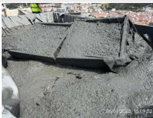
Provetes para ensaio de Absorção de Energia – GR P518 / 0079514;
