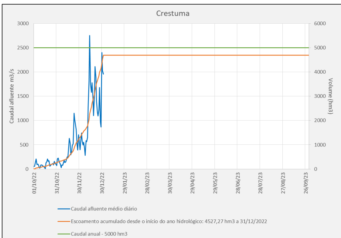
Figura 12 – Caudal médio diário e Volumes acumulados na seção da barragem de Crestuma na Bacia do rio Douro, em Portugal.
