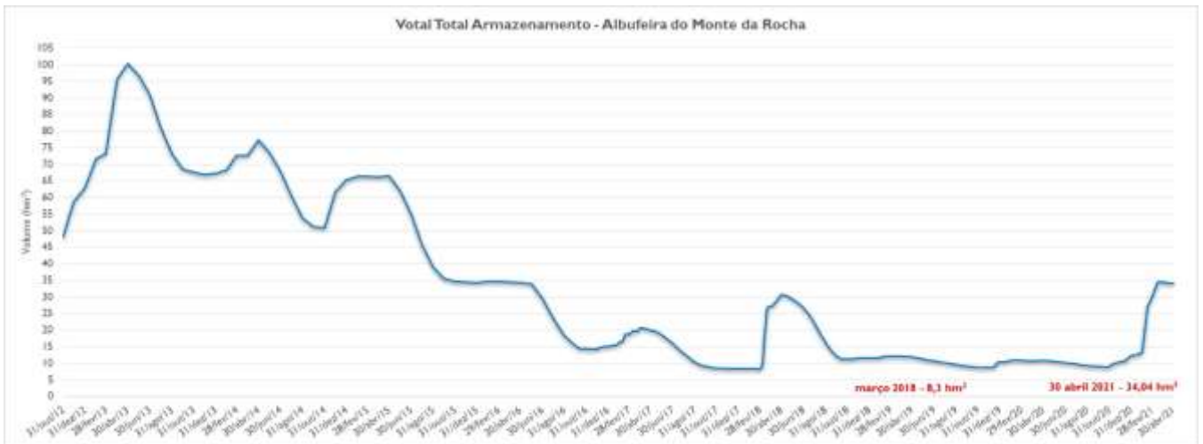
Figura 29. Volume armazenado na albufeira de Monte da Rocha. (Fonte: AdP).
