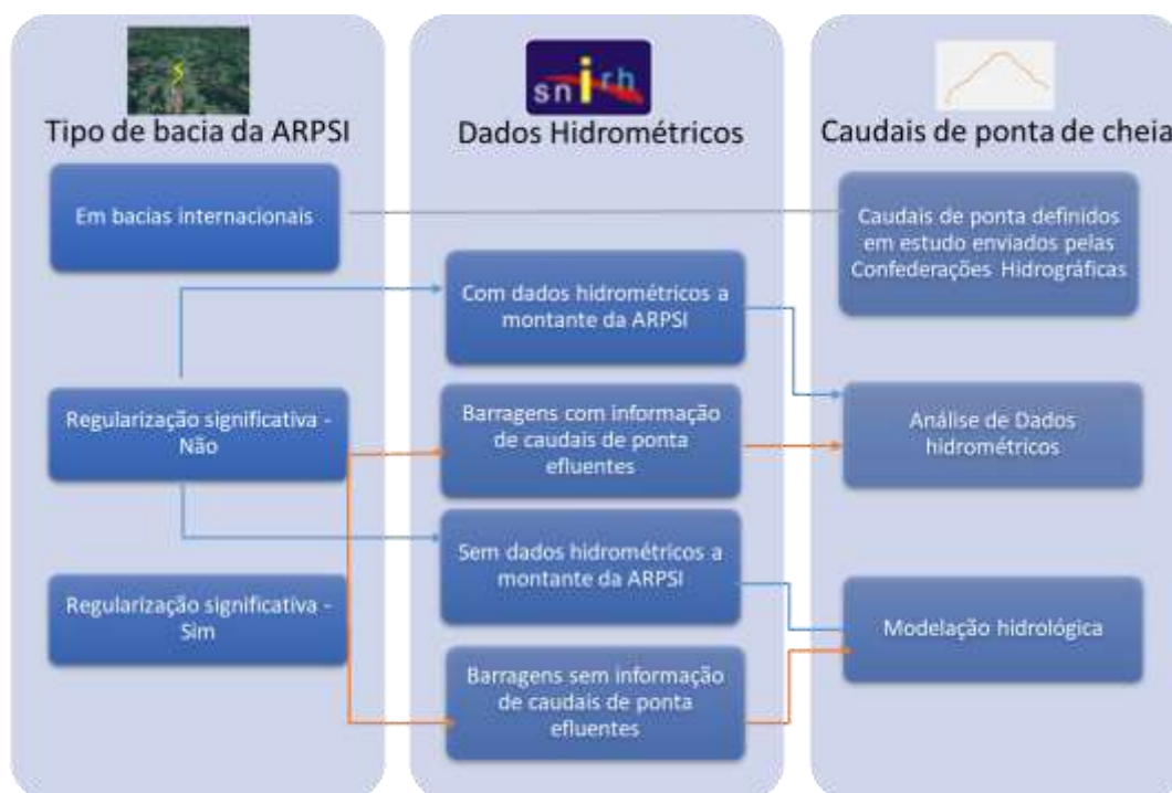
Figura 8. Esquema da modelação hidrológica (Aqualogus e Hidromod, 2020)
