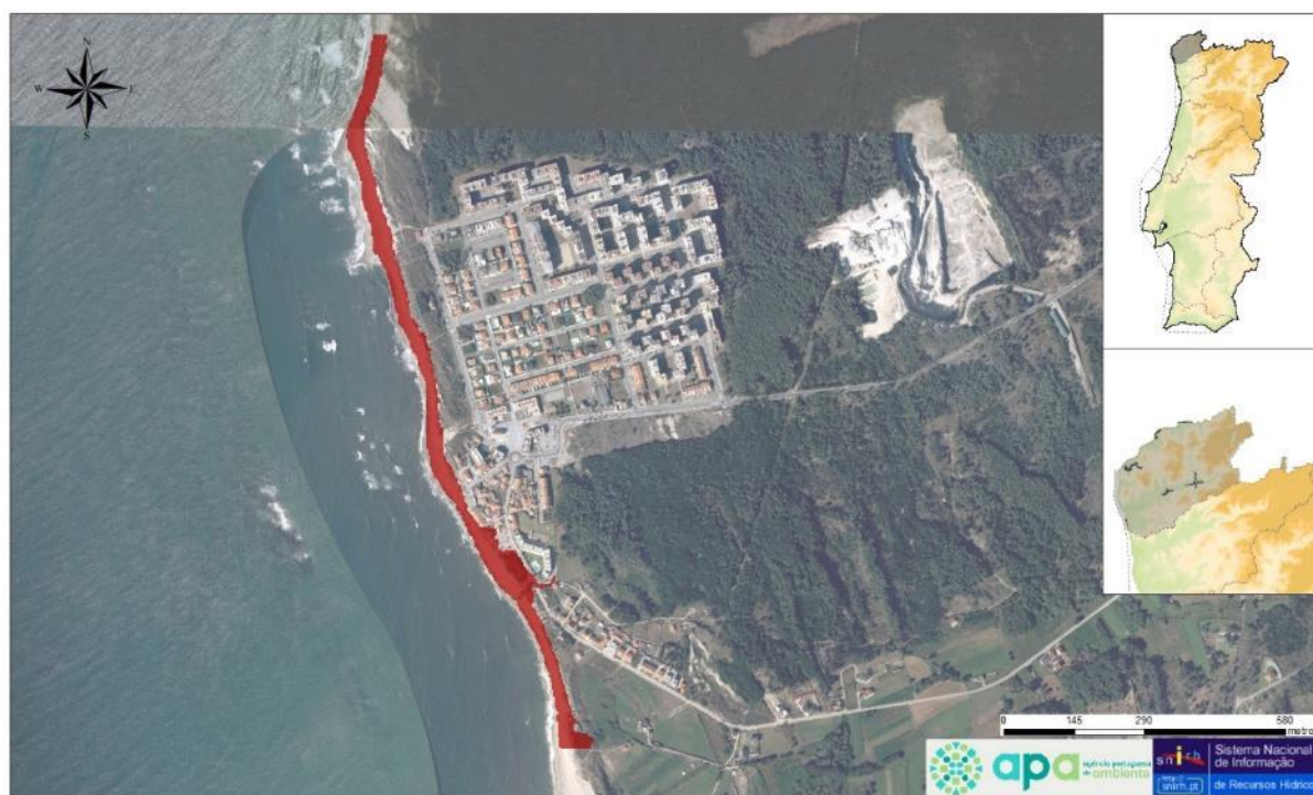
Figura 17 - Área inundada para o período de retorno de 100 anos, ARPSI da Amorosa (PTRH1Costeira01)
