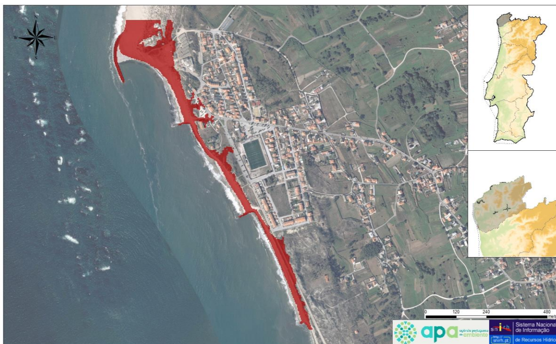
Figura 19 - Área inundada para o período de retorno de 100 anos, ARPSI da Castelo de Neiva (PTRH1Costeira02)
