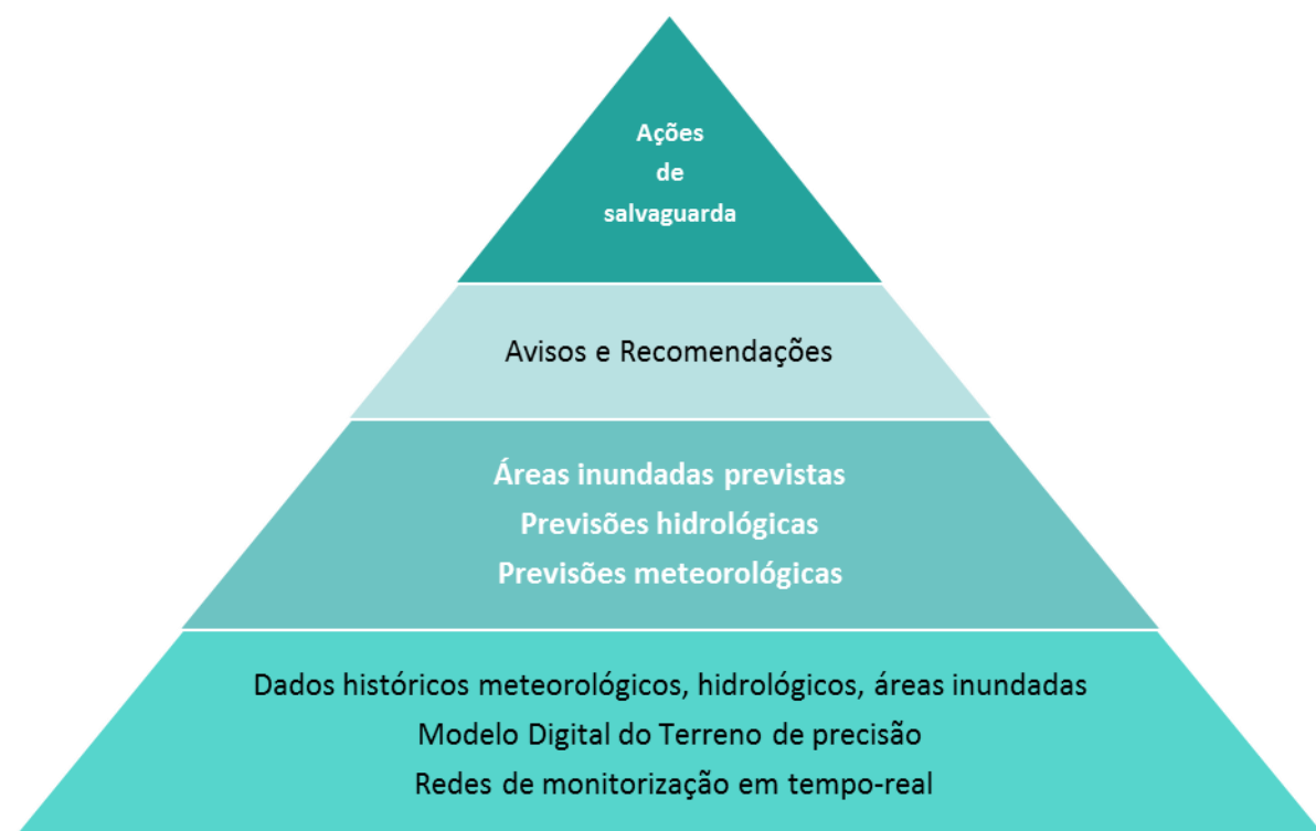
Figura 38 - Componentes de um Sistema de alerta e previsão (Adaptado de WMO, 2018)
