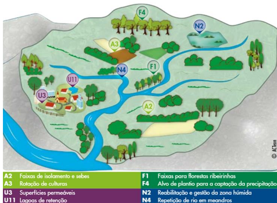
Figura 41 - Representação esquemática de uma bacia hidrográfica e implementação de medidas verdes (Adaptado de NWRM, 2013)
